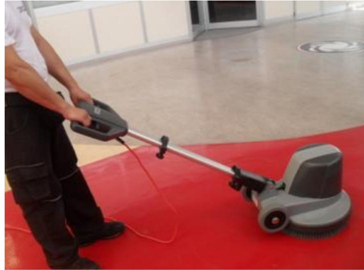
6. Presser le bouton de sécurité et activer les leviers de commande pour démarrer la machine : démarrage en douceur et enclenchement automatique de la brosse
