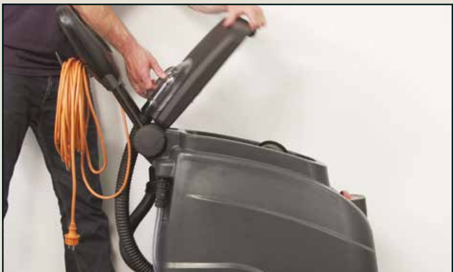
Laissez le réservoir de récupération ouvert
