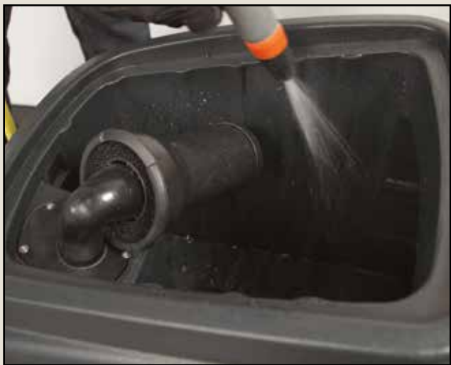
Nettoyez le réservoir de récupération
