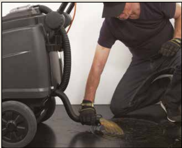
Videz le réservoir de récupération à l'aide du flexible de drainage
