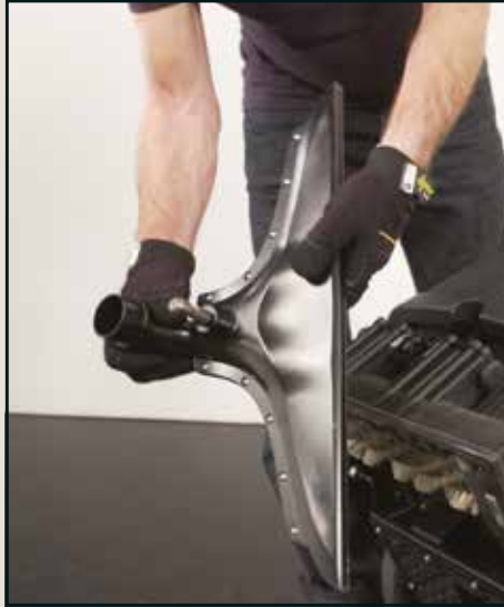
Sortez la brosse par le côté gauche et nettoyez-la. Pour la réinstaller, raccordez d'abord le côté droit puis poussez sur le côté gauche de la brosse. Sortez la buse d'aspiration et nettoyez-la
