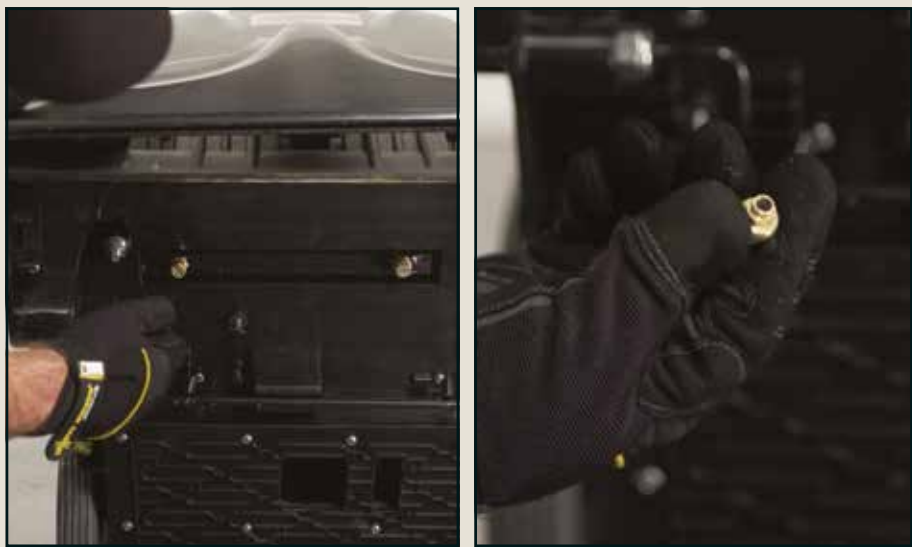
Lorsque la brosse est sortie, nettoyez le compartiment de la brosse et si nécessaire, vérifiez les deux buses de pulvérisation
