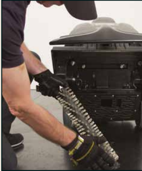
Sortez la brosse par le côté gauche et nettoyez-la. Pour la réinstaller, raccordez d'abord le côté droit puis poussez sur le côté gauche de la brosse. Sortez la buse d'aspiration et nettoyez-la
