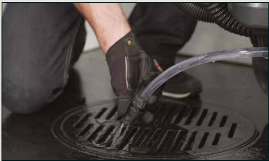
Videz le réservoir de solution
