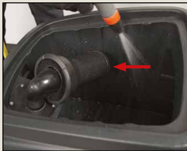
Vérifiez le système de flotteur à l'intérieur. Nettoyez le joint du couvercle
