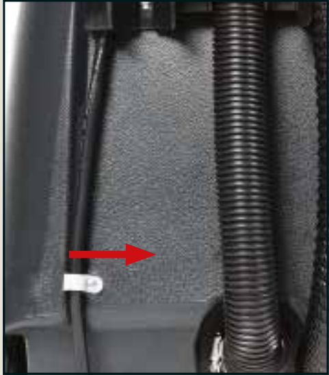
Vous pouvez accéder au filtre depuis la partie inférieure de la machine. Le filtre doit rester propre
