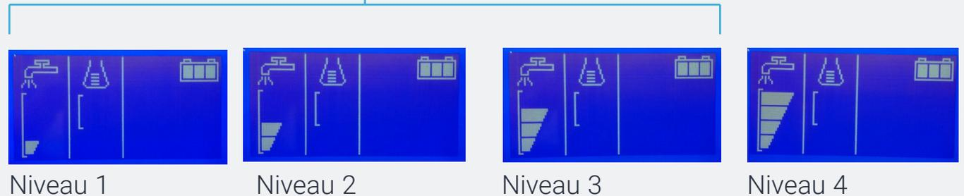
La productivité en m<sup>2</sup> avec 1 réservoir (niveau de solution 1 et vitesse moyenne de 2 km/h) est de **50 à 70 % plus élevée** avec une solution contrôlée par la vitesse par rapport à celle en litre/minute.
