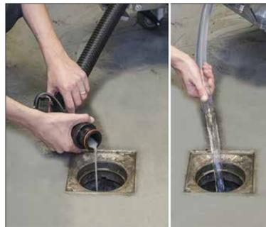
13 Videz le réservoir de récupération à l'aide du flexible de vidange. Videz ensuite le réservoir de solution à l'aide du tuyau transparent.
