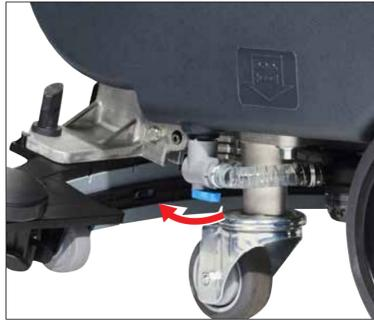
2. Vérifiez que la vanne de solution située sous la machine est bien ouverte.
