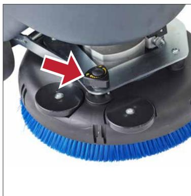
1. Pour modifier la direction de la machine, tournez le bouton avant jusqu'à ce que la machine avance en ligne droite.
