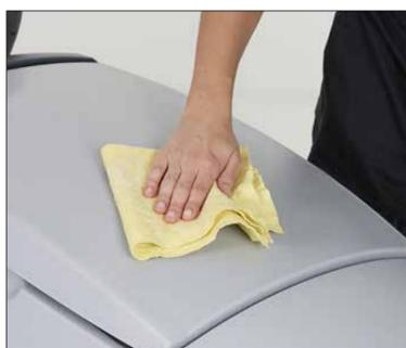
17 Nettoyez la machine à l'aide d'un chiffon humide et au besoin, utilisez un produit de nettoyage neutre.
