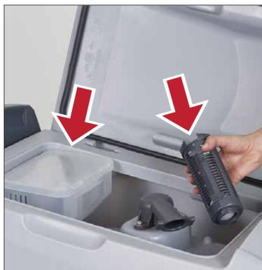
2. Ouvrez le réservoir de récupération et vérifiez que le tamis et le flotteur sont propres et fonctionnels.
