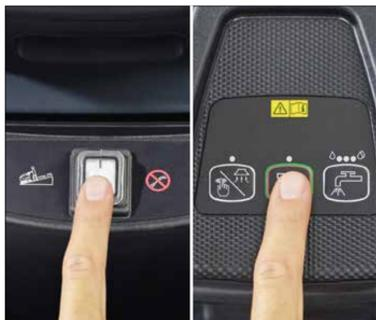
6. Appuyez sur l'interrupteur principal pour le mettre en position « I », appuyez sur la touche principale (LED allumée) pour mettre la machine en marche.
