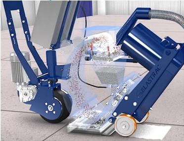
Conexión a máquinas de granallado para la recogida de residuos de cemento – operación de proceso.
