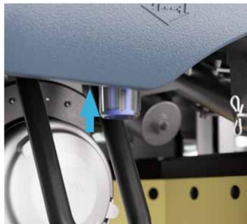
2. Kontrollieren Sie, ob die Reinigungslösung zum Deck fließt. Ist dies nicht der Fall, überprüfen Sie, ob der Lösungsbehälter leer und das Lösungsventil geöffnet ist.
