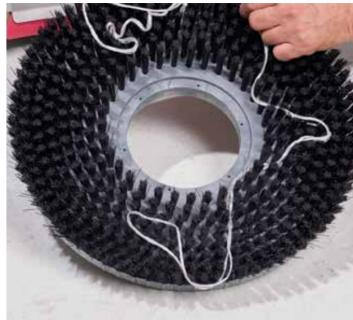
3. Drehen Sie die Bürsten gegen den Uhrzeigersinn und entnehmen Sie diese. Prüfen Sie, ob sich Materialien in der Bürste gefangen haben und entfernen Sie diese.
