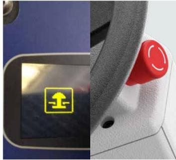
2. Wenn das Not-Aus-Symbol auf dem Display angezeigt wird, drehen Sie den Knopf bis er herauspringt, um die Maschinenfunktion wieder zu aktivieren.
