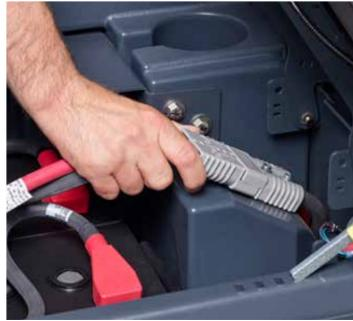
3. Kontrollieren Sie, ob die Batteriesteckverbindung richtig angeschlossen ist.
