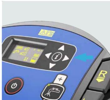
2. Drücken Sie auf „i“ und navigieren Sie nach unten zu den Fehlermeldungen. Mit der Taste „>“ können Sie sich die Fehlermeldungen anzeigen lassen.
