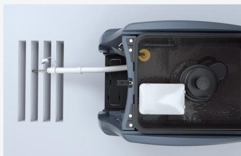
**4** Videz le réservoir d'eau sale avec le tuyau et rincez doucement le réservoir
