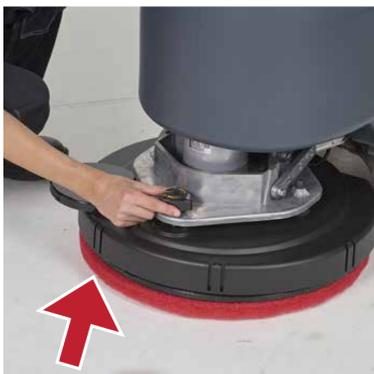
1 Pour ajuster l'orientation de la machine, faites tourner le bouton avant jusqu'à ce que la machine avance droit.
