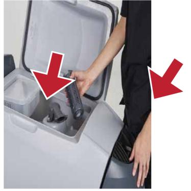
2 Ouvrez le réservoir de récupération et vérifiez que le tamis et le flotteur sont propres et fonctionnels.
