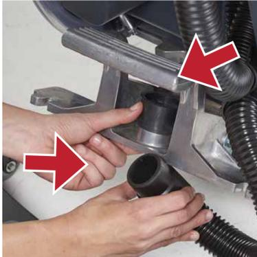
1 Vérifiez si le flexible d'aspiration est correctement installé et nettoyé.
