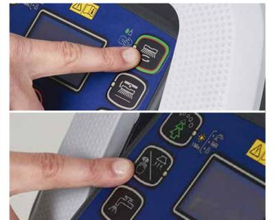
6. Insérez la clé utilisateur, puis faites démarrer la machine en appuyant sur le bouton One-Touch. Pour enclencher la brosse, actionnez les manettes de commande, puis relâchez les.
