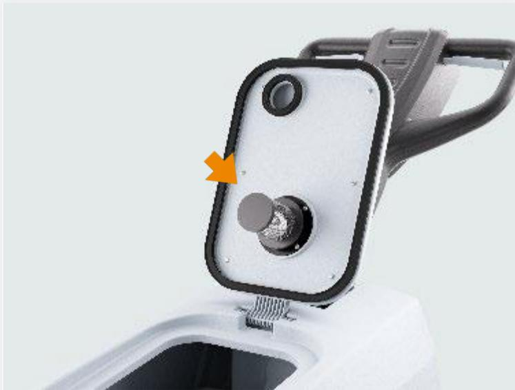
Automatisches Schwimmersystem blockiert das Absaugen, wenn der Schmutzwassertank voll ist
