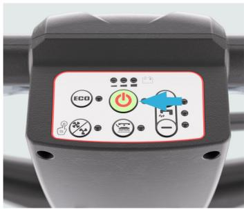
1. Démarrez la machine et vérifiez que le niveau de batterie est suffisant pour le nettoyage. Rechargez la batterie si nécessaire.
