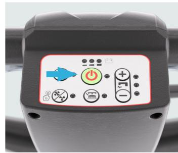
4. Mettez la machine en marche et pressez, l'un des interrupteurs de sécurité de la poignée pour activer la brosse/le plateau. Si nécessaire, répétez la procédure jusqu'à ce que les brosses/le support disque soient enclenchés. L'embouchure est relevée/descendue avec le bloc de lavage.
