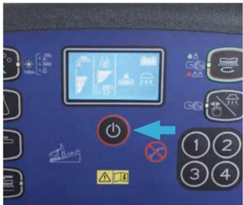
**1.** Schalten Sie die Maschine ein und geben Sie den voreingestellten Code 1, 2, 3 und 4 ein, prüfen Sie den Batterieladezustand. Laden Sie die Batterien auf, falls erforderlich.
