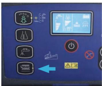
**16.** Drücken Sie den Click-Off-Button, entfernen und kontrollieren Sie die Bürsten.
