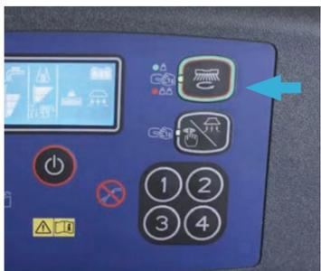
**6.** Durch Drücken der grünen Taste am Gerät werden die Bürsten abgesenkt. Zum Einschalten der Bürsten den Antriebshebel leicht betätigen und wieder loslassen.
