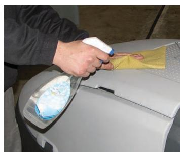
**17.** Reinigen Sie die Maschine mit einem feuchten Tuch und verwenden Sie bei Bedarf ein neutrales Reinigungsmittel.
