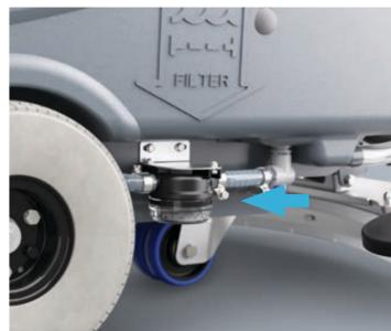
**14.** Reinigen Sie den Filter regelmäßig: Schließen Sie den Wasserhahn unter der Maschine, entfernen Sie den Filter, reinigen Sie ihn und setzen Sie ihn wieder ein.
