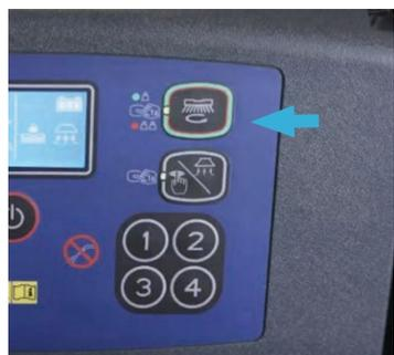
4. Beim Starten der Maschine blinkt die One-Touch-Taste und die Bürsten funktionieren nicht. Die Maschine wurde ausgeschaltet, ohne zuerst das Bürstenmodul anzuheben. Warten Sie, bis sich das Bürstenmodul wieder angehoben hat, bevor Sie die Bürsten erneut aktivieren, indem sie die One-Touch-Taste erneut betätigen.
