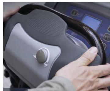
**10.** Zum Starten des Reinigungsvorgangs den Fahrhebel nach vorne bewegen. Die Höchstgeschwindigkeit wird mit dem Drehregler eingestellt. Zum Rückwärtsfahren den Fahrhebel nach hinten bewegen.
