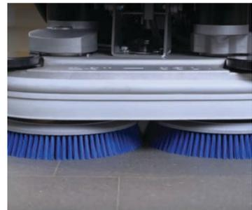
**5.** Stellen Sie die Bürsten oder die Padhalter unter das Deck. Verwenden Sie die entsprechenden Bürsten/Pads, um den Boden zu reinigen.
