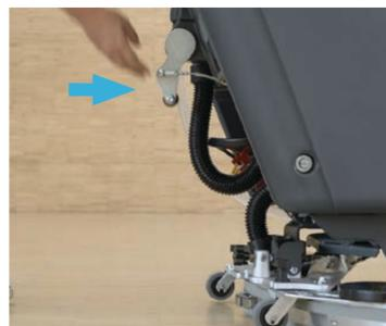
**9.** Senken Sie die Saugleiste mit dem Hebel ab.
