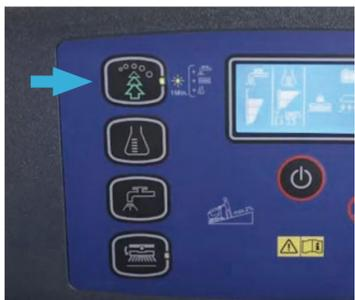
**11.** Wenn vorübergehend eine höhere Reinigungsleistung benötigt wird, die EcoFlex™-Taste betätigen.
