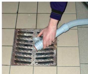
**12.** Bei Arbeitsende den Schmutzwassertank mit dem Schlauch entleeren. Biegen Sie den weichen Teil des Schlauches vor dem Entfernen der Kappe, um den Durchfluss zu steuern.
