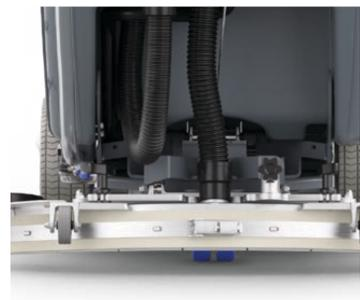
**15.** Entfernen Sie die Saugleiste und reinigen Sie diese. Überprüfen Sie die Sauglippen, drehen oder ersetzen Sie sie bei Bedarf.
