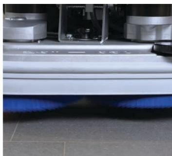
2. Während des Betriebs zeigt das Display folgendes an "WARNUNG ALARM E17" - Die Bürstenmotoren sind überlastet. Verwenden Sie weniger aggressive Bürsten und/oder vermeiden Sie das Arbeiten mit eingeschaltetem zusätzlichem Druck.
