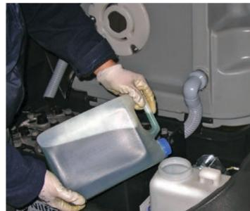
**4.** Füllen Sie den EcoFlex-Tank mit einer für die auszuführenden Arbeiten geeigneten Reinigungsmittellösung (hochkonzentriertes, wenig schäumendes Reinigungsmittel).
