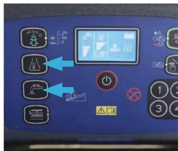
**7.** Je nach Art der durchzuführenden Reinigung die Tasten für die Durchflusskontrolle betätigen.
