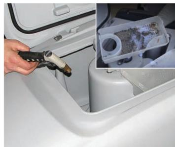
**13.** Den Schmutzwassertank und den Saugkorb inkl. Schwimmer mit sauberem Wasser abspülen. Entfernen, leeren und reinigen Sie den Grobschmutzbehälter.
