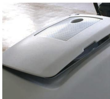
4. Schließen Sie die Abdeckung des Schmutzwasserbehälters, vergewissern Sie sich, dass die Dichtung richtig schließt und keine Falschlucht angesaugt wird.
