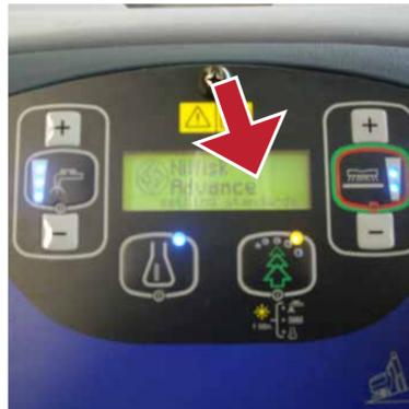
2 Vérifiez qu'il n'y a pas de surcharge au niveau du moteur de brosse, c.-à-d. 3 voyants de batterie clignotent simultanément ou un code d'erreur s'affiche.
