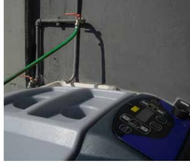
2. Remplissez le réservoir d'eau claire. La température de l'eau ne doit pas dépasser 40 °C.
