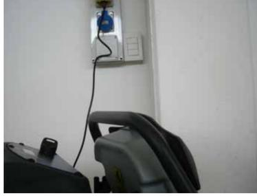
1b. Déconnectez le câble du chargeur de la batterie de l'alimentation électrique.
