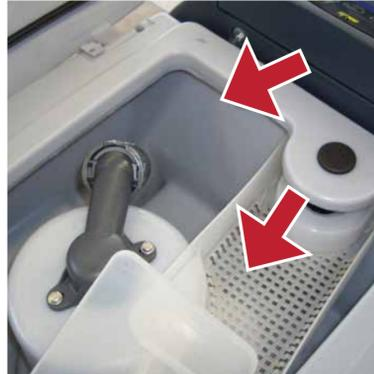
2 Ouvrez le réservoir de récupération et vérifiez si la grille d'aspiration et le joint sont propres.
