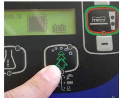
9. Appuyez sur l'interrupteur EcoFlex™ lorsque vous avez temporairement besoin d'une plus grande puissance de nettoyage.
