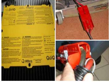
1a. Éteignez le chargeur en appuyant sur le bouton STOP. Déconnectez le câble du chargeur de la prise rouge de la batterie. Rebranchez la prise de batterie rouge sur la machine.
