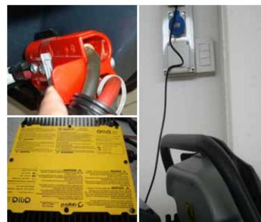
18. Chargez les batteries : connectez le câble du chargeur de la batterie à partir de l'alimentation électrique.
