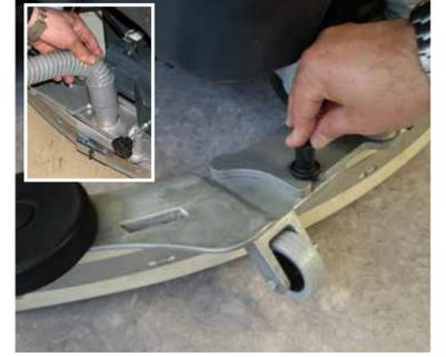
4. Installez l'embouchure et fixez-la à l'aide des papillons puis connectez le flexible d'aspiration.
