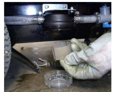
14. Nettoyez le filtre en : 1) fermant le robinet de solution situé sous la machine. 2) retirant le couvercle transparent et le joint, puis en retirant le tamis du filtre.
