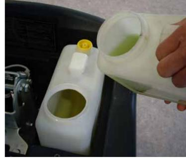
3. Remplissez le réservoir EcoFlex avec un détergent adapté au travail à effectuer (détergent hautement concentré).
