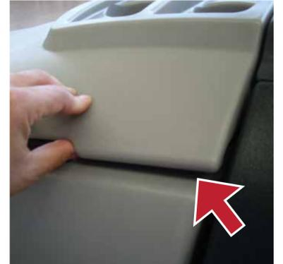
4 Fermez le capot du réservoir de récupération correctement et/ou vérifiez que le joint n'est pas usé.
