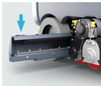
14. Deslizándola hacia fuera, compruebe, vacíe y limpie la tolva de residuos (versión cilíndrica).
