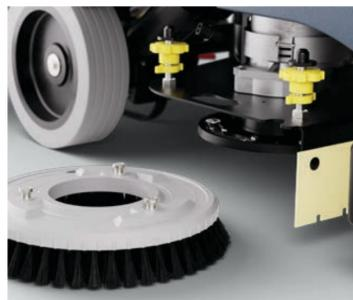
7. Instale manualmente los cepillos circulares o los impulsores de las pastillas. El cepillo de disco o los porta pad.
