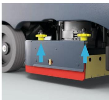
1. Retire el conjunto del faldón lateral y compruebe la instalación y el estado del cepillo.
