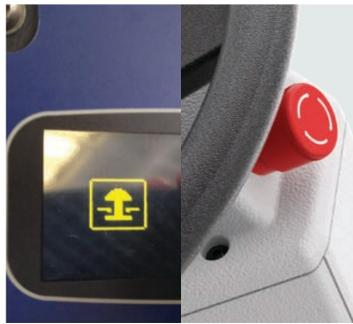
2. Icono de parada de emergencia que aparece en la pantalla cuando se activa el interruptor de parada de emergencia. Gire el interruptor hasta que vuelva a su posición inicial para habilitar el funcionamiento de la máquina.
