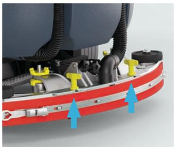
16. Afloje las palometas amarillas, retire el labio de goma y elimine los residuos. Compruebe y limpie los labios de la boquilla.
