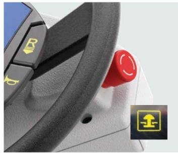
2. Icono de parada de emergencia que aparece en la pantalla cuando se activa el interruptor de parada de emergencia. Gire el interruptor hasta que vuelva a su posición inicial para que habilite el funcionamiento de la máquina.
