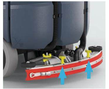
5. Compruebe que los labios de goma no presenten daños e instale la boquilla girando las palometas de sujeción amarillas. Compruebe la altura de la boquilla ajustando las ruedas giratorias y el regulador del ángulo.
