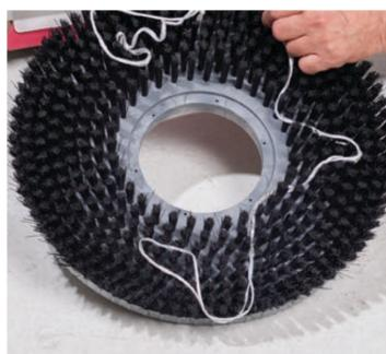
3. Gire los cepillos en el sentido contrario a las agujas del reloj y compruebe si hay materiales externos que alteren el funcionamiento.
