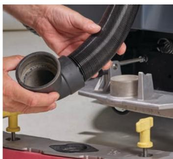
1. Compruebe si la manguera de aspiración está limpia e instalada correctamente.
