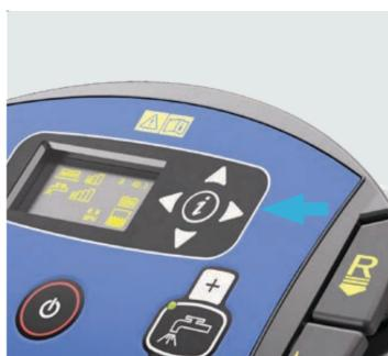
2. Pulse "I" para desplazarse hacia abajo hasta los fallos y pulse el botón ">" para ver los fallos.
