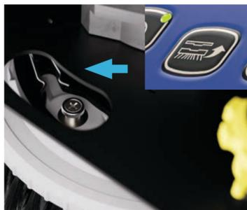
8. Levante el cepillo y gírelo hacia la izquierda para fijarlo en su posición. Si tiene la opción Click on instalada, alinee el cepillo directamente debajo del motor utilizando el sistema de alineación y pulse el botón de instalación del cepillo. (Solo para la versión de disco).
