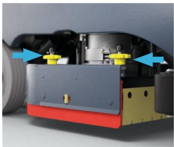
6. Instale los cepillos quitando los faldones laterales, que pueden retirarse fácilmente desenroscando las tuercas de sujeción amarillas.
