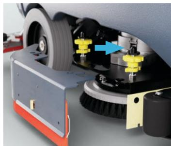
9. Vuelva a colocar los faldones laterales en su posición para un fregado normal. Si quiere realizar un fregado doble debe colocar los faldones laterales sobre los pins negros.
