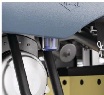
2. Verifique que la solución fluya hacia la plataforma. Si no es así, verifique que el depósito de solución no esté vacío y que la válvula de solución esté abierta.
