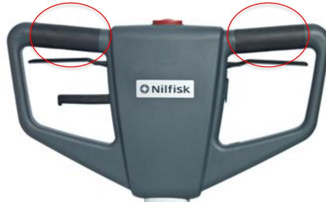
2. Leviers de sécurité, la machine s'arrête quand le levier de commande est lâché
